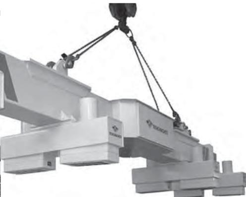
Выбор магнитных направляющих стоек позволяет поднимать грузы разной длины, как указано ниже:
