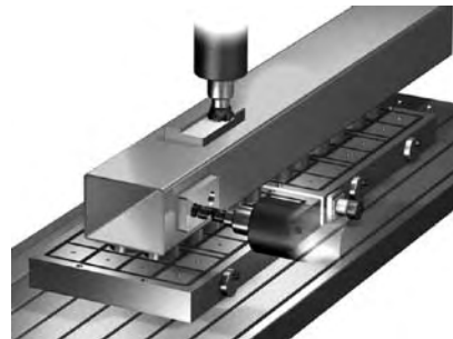
Figur 8.7F - Profilering och borrarbning av rör
