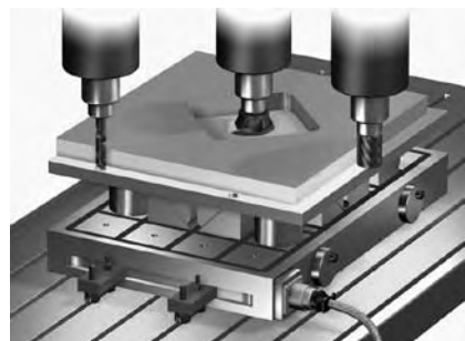
Figur 8.7D - Vältning, grovslipning, frigörande och finslipning av yta 2
