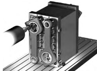
Figur 8.7L - Planslipning, profilering och borring av delar av smält stål
