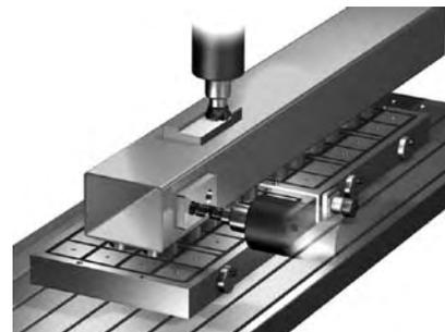
Figura 8.7F - Encabezado y perforado de tubos
