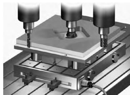
Figura 8.7D - Vuelco, desbastado, destensado y acabado 2a cara
