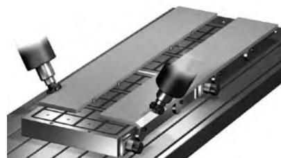
Figura 8.7G - Perfilado de cuchillas y biselado de chapas
