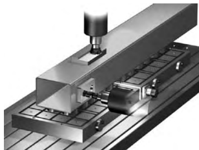
图8.7F — 管状对接和削孔
