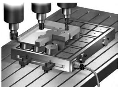
图8.7A — 削平面、削孔、模具腔槽制作
