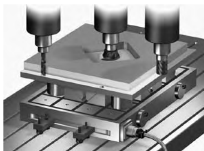
图8.7D — 翻转、粗加工、解除张力和第2面精加工
