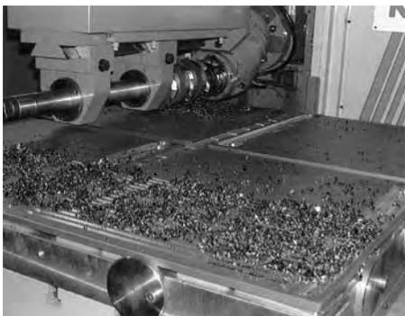
Uma elaboração típica que pode ser executada em plano magnético é a planagem das placas. Uma vez que se providencie a limpeza da placa contra eventuais incrustações e rebarbas que podem aumentar o entreferro e reduzir a força de fixação (capítulo 4.3), se posiciona a peça a ser usinada e se efetua um espessamento manual.
