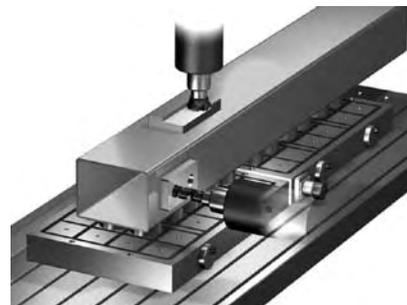
Figura 8.7F - Traçamento e furação dos tubulares
