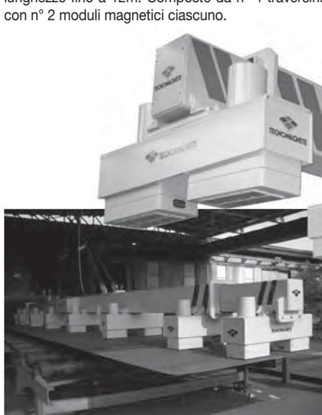
**TM 6/N:** per movimentazione unitaria di lamiera con lunghezze fino a 16m. Composte da n° 6 traversini con n° 2 moduli magnetici ciascuno.
