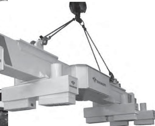
Selezionando i traversini magnetici necessari è possibile sollevare carichi di diverse lunghezze secondo il seguente schema:
