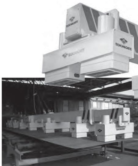
**TM 6/N:** para movimentação unitária de placas com comprimento de até 12 m. Compostos por 6 Traves cada um com 2 módulos magnéticos.
