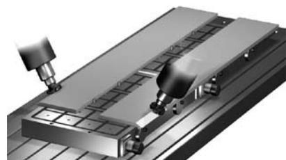
Figura 8.7G - Profilatura lame e bisellatura lamiere
