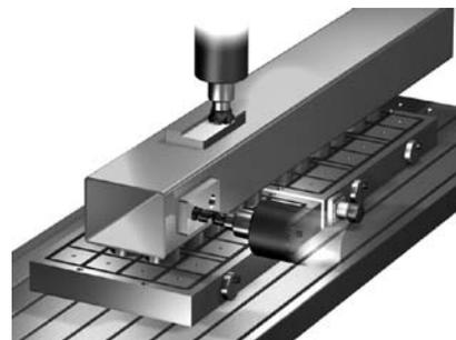
Figura 8.7F - Intestatura e foratura tubolari
