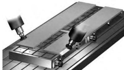
Resim 8.7G - Bıçaklara profil açılması ve sacların pahlanması
