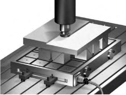
Resim 8.7C - Yüzey kaba işleme
