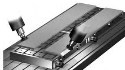
Рис. 8.7G - профилирование ножей и снятие фаски листов
