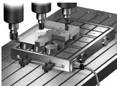
Afbeelding 8.7A - Vlakfrezen, boren, afdrukken maken
