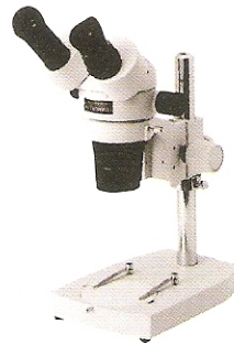
高解析度立體顯微鏡可調固定倍率No.SM-FIM9000
